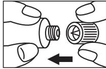
●請將蓋子反轉，以尖端抵住軟管前端並用力壓下。
