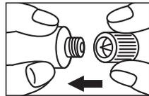
●请将盖子顶部的突起部位用力压向管口。
